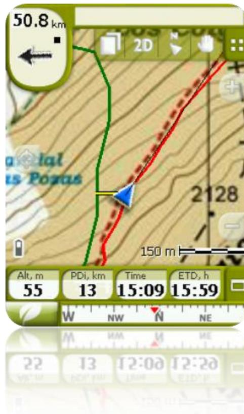
**Führungslinie:** Ihre Position wird auf dem Track mittels einer senkrechten Linie dargestellt. Wenn Sie sich mehr als 50 Meter vom Track entfernen, wird diese Linie rot angezeigt.
