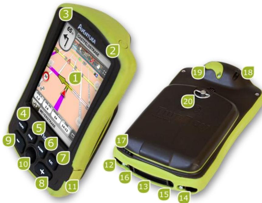
1. **Touchscreen:** Dies ist das wichtigste Arbeitswerkzeug des TwoNav Aventura und ermöglicht Ihnen den Zugriff auf fast alle Funktionen des Gerätes. Sie können die Funktion auf dem Display kurz antippen oder mehrere Sekunden lang drücken (um das [Kontextmenü](#) zu öffnen) oder auf ihm eine Linie ziehen (um die Karte oder die listen zu bewegen).
