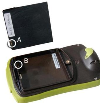
3. Setzen Sie die Klappe wieder ein und achten Sie darauf, dass sich der untere Teil der Klappe in der richtigen Position befindet. Verriegeln Sie das Gerät anschließend mit drei Umdrehungen des Öffnungsringes in Uhrzeigerrichtung wieder.
