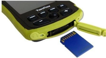
3. Schließen Sie das SD-Kartenfach wieder. Achten Sie dabei darauf, dass sich der Gummi in der richtigen Position befindet. Hierdurch verhindern Sie das Eindringen von Wasser und Staub in das Gerät.
