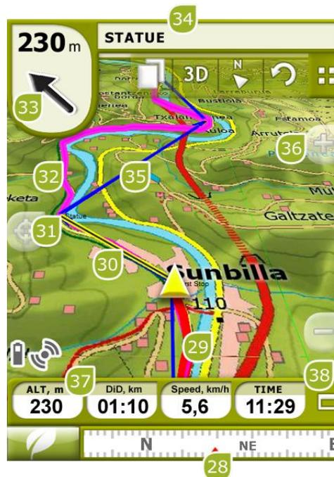
28. **Bussola:** Indica l'orientamento del dispositivo. L'origine di questo dato (GPS, bussola elettronica o 'automatico') può essere impostata da [Menu > Parametri > Off-road > Orientamento](#). [Translate] When current GPS position is inside radius of a waypoint, waypoint name will appear. If waypoint has an associated file, it can be reproduced clicking on its name.[/Translate]
