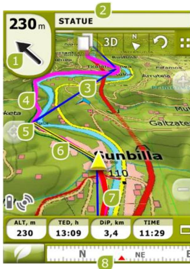
1. **Freccia GOTO:** Direzione in cui si trova il waypoint successivo. Durante la navigazione di una traccia, essa indicherà la sua direzione (vedi [navigazione Off-road](#)).
