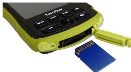
3. Richiudere il tappo della scheda SD. Verificare che il tappino di gomma sia correttamente inserito per evitare che un parziale inserimento possa permettere all'acqua o alla polvere di entrare dentro il dispositivo.
