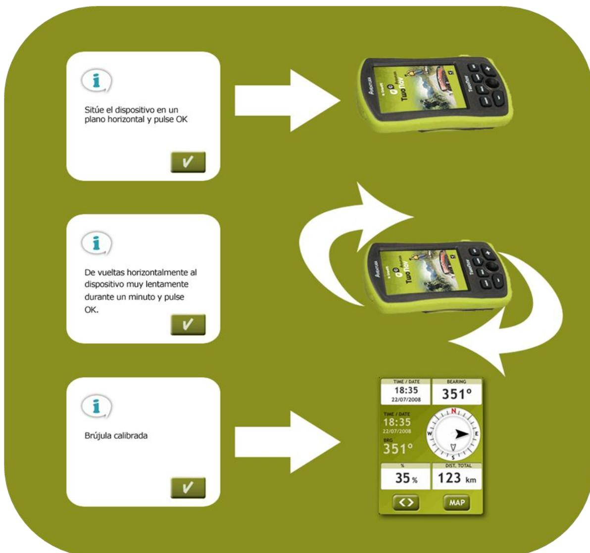
**Nota:** E' molto importante che quando viene effettuata la calibrazione della bussola, il dispositivo sia orizzontale (ad esempio, posato su un tavolo) e che non sia vicino ad oggetti metallici o forti campi magnetici. Per ottenere una più accurata calibrazione il dispositivo deve essere ruotato lentamente e con continuità.
