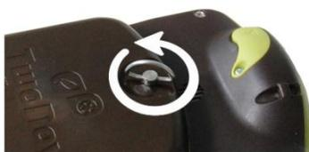
2. Posizionate la batteria Li-Ion che troverete nella confezione degli accessori inclusi nella scatola di Aventura. I tre connettori metallici della batteria dovranno combaciare con i tre piolini posti all'interno del vano batteria.
