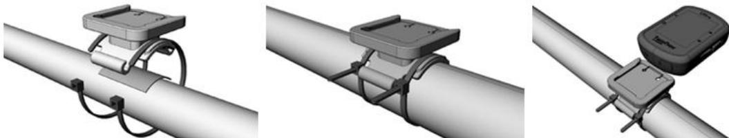
TwoNav Ultra se puede montar en posición horizontal o vertical. Puede seleccionar el grado de rotación de la pantalla desde '*Menú principal > Configuración > Visualización > Rotar pantalla*'.
