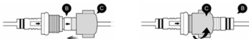
4. Vissez la protection C pour renforcer la connexion.
