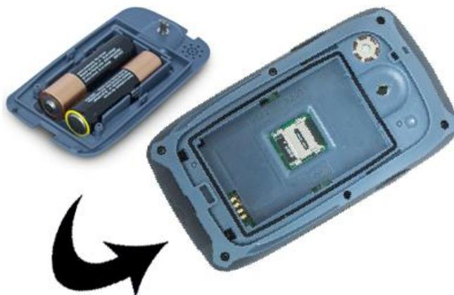
1. Öffnen Sie das Batteriefach (ziehen Sie fest, um das Fach komplett herauszunehmen). Forcieren Sie die Öffnung des Ringes nicht.
