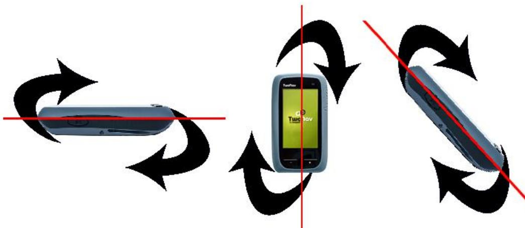
**WICHTIG:** Der elektronische Kompass ist ein Instrument, das sehr empfindlich auf atmosphärische Bedingungen und auf Magnetfelder reagiert. Die Kalibrierung muss unter freiem Himmel und fern ab von Quellen erfolgen, welche das Magnetfeld verändern (Kraftfahrzeuge, Gebäude oder elektrische Leitungen).
