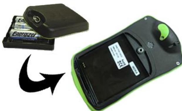
1. Ouvrir le compartiment de la batterie en faisant 4 tours complets à l'aide de l'anneau, dans le sens contraire des aiguilles d'une montre (tirer ensuite avec force pour enlever complètement le compartiment). Ne pas forcer sur l'anneau lors de l'ouverture.
