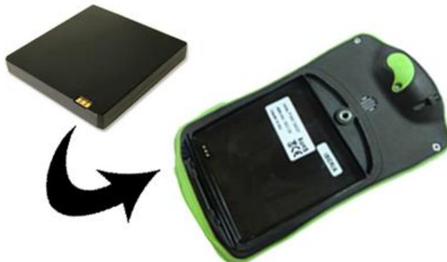
1. Ouvrir le compartiment de la batterie en faisant 4 tours complets à l'aide de l'anneau, dans le sens contraire des aiguilles d'une montre (tirer ensuite avec force pour enlever complètement le compartiment). Ne pas forcer sur l'anneau lors de l'ouverture.
