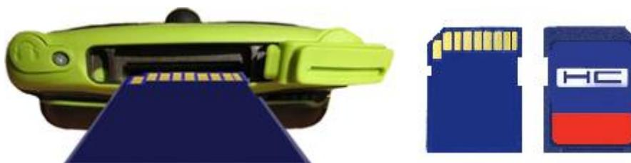
1. Retirez le bouchon en caoutchouc de la carte SD situé sur la partie inférieure du GPS.
