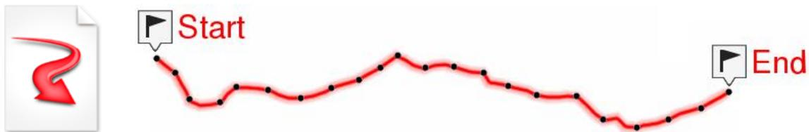
Une trace est un ensemble de points ordonnés par temps, contenant chacun de l'information sur les coordonnées de position, heure, date et dans la plupart des cas d'altitudes.
