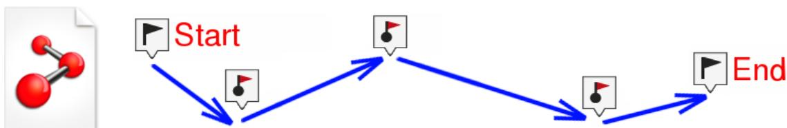
Une route est un ensemble de waypoints ordonnés de façon prédéterminée. Il s'agit d'une façon de naviguer qui permet de planifier une direction d'un lieu à un autre en passant par plusieurs waypoints. Les routes sont utilisées lorsqu'il n'est pas possible d'accéder à un lieu d'une manière directe (en ligne droite).
