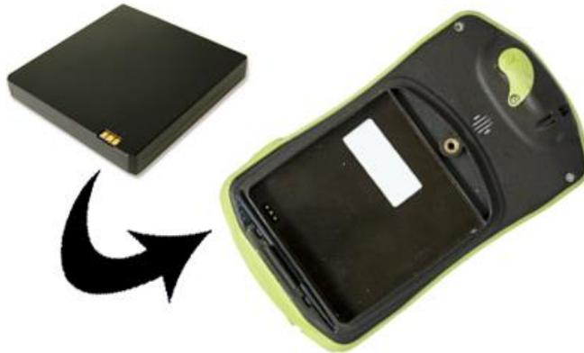
1. Aprire il vano della batteria facendo 4 giri completi con l'anello di apertura in senso antiorario (tirare con forza per rimuovere completamente il coperchio). Non forzare l'anello di apertura.
