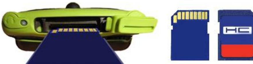
1. Aprire il vano della scheda nella parte inferiore del dispositivo.
