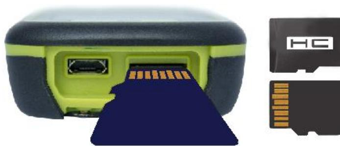
1. Retirez le bouchon en caoutchouc de la carte microSD situé sur la partie inférieure du GPS.
