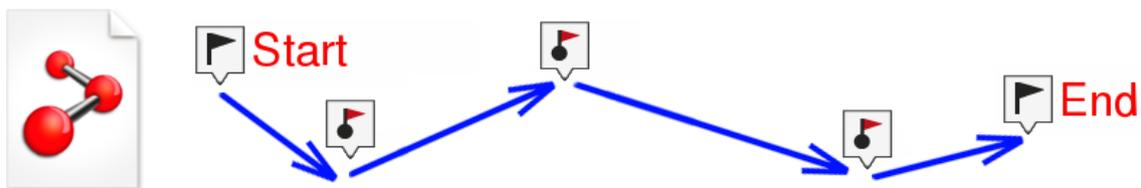
Eine Route ist eine Gruppe von Wegpunkten, die in vorbestimmter Weise geordnet sind. Das ist eine Form des Navigierens, bei dem der Kurs von einem Ort zum anderen über mehrere Wegpunkte geplant werden kann. Routen werden benutzt, wenn es nicht möglich ist, zu einem Ort direkt (in Luftlinie) zu gelangen.
