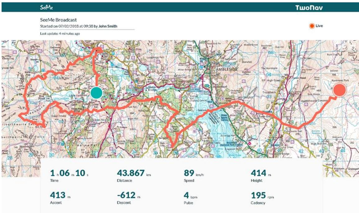
Ihr Gerät versendet in Zeitabständen (5 Min.) Ihre Position mit mehreren Punkten bei jedem Versandt. Wenn Sie an einem Punkt auf Ihrer Strecke das Signal GPRS verlieren sollten, werden Ihre Daten gespeichert und übermittelt, sobald das Signal wieder zur Verfügung steht. Die Übertragung endet in dem Moment, an dem Sie Ihre Aktivität beenden. Wenn Sie das nicht tun, endet sie automatisch, wenn während 1 Stunde keine Positionen erhalten werden.
