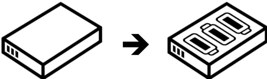
È possibile di aumentare l'autonomia GPS sostituendo la batteria standard del GPS con l'accessorio batteria AA. Questo accessorio sostituisce la batteria ioni di litio per batterie AA di uso comune. Puoi acquistare tali batterie in qualsiasi negozio.
