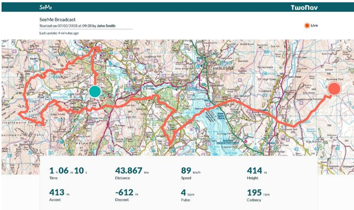
Ihr Gerät versendet in Zeitabständen (5 Min.) Ihre Position mit mehreren Punkten bei jedem Versandt. Wenn Sie an einem Punkt auf Ihrer Strecke das Signal verlieren sollten, werden Ihre Daten gespeichert und übermittelt, sobald das Signal wieder zur Verfügung steht. Die Übertragung endet in dem Moment, an dem Sie Ihre Aktivität beenden. Wenn Sie das nicht tun, endet sie automatisch, wenn während 1 Stunde keine Positionen erhalten werden.
