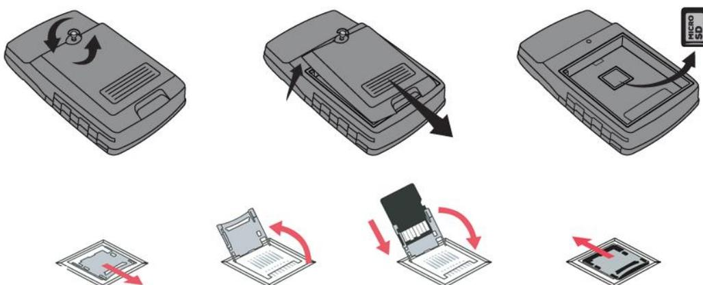
Le GPS est capable de lire des cartes microSD de quelconque capacité utilisant les systèmes de fichiers FAT32, ExFAT et NTFS. La carte microSD permet la lecture de cartes, mais celle-ci n'est pas en mesure de lire d'autres types de fichier (traces ou waypoints). Il est recommandé d'enregistrer les cartes dans le répertoire racine et d'éviter tout enregistrement dans des sous-répertoires.
