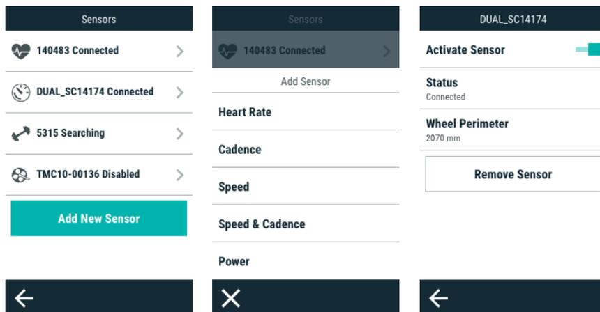
5. En algunos sensores deberá especificar algunos detalles técnicos. A continuación se iniciará el proceso de vinculación entre el dispositivo y el sensor.
