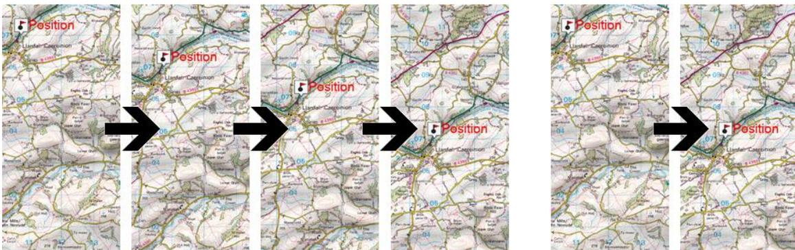
Durante la navegación o la edición puede mover el mapa para visualizar otras partes del terreno. Si así lo hiciera, perdería la referencia actual, pulse el botón 'Recentrar' para que TwoNav se centre de nuevo en su referencia. TwoNav dispone de un sistema automático de recentro, de modo que si no mueve el mapa manualmente, éste volverá a centrarse en su posición actual de acuerdo con el valor definido.
